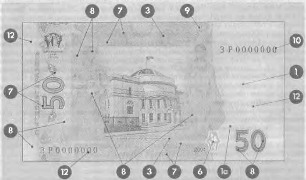
Мал. 67. Банкнота достоїнством 50 гривень Національного банку України серії 2004 р. вигляд зі зворотнього боку. 1. Місце розміщення водяного знака. 1а. Місце розміщення світлого елемента водяного знака. 2. Цифрове позначення номіналу, надруковане фарбою, що змінює свій колір під час розглядання банкноти під різними кутами зору: малиново-фіолетовий – під час розглядання зображення цифри "50" перпендикулярно до поверхні зображення; оливково-зелений – під час розглядання його під гострим кутом. 3. Місце, де надрукована вертикально захисна кодова стрічка. 4. Латентне (приховане) зображення. 5. Рельєфні зображення. 6. Наскрізний елемент (суміщене зображення). 7. "Орловський" друк. 8. Мікротекст. 9. Райдужний друк. 10. Серійний номер надрукований високим друком фарбою чорного кольору, що має магнітні властивості. 11. Серійний номер надрукований фарбою червоного кольору, що світиться жовто-червоним кольором в ультрафіолетових променях. 12. Антисканерна сітка.
