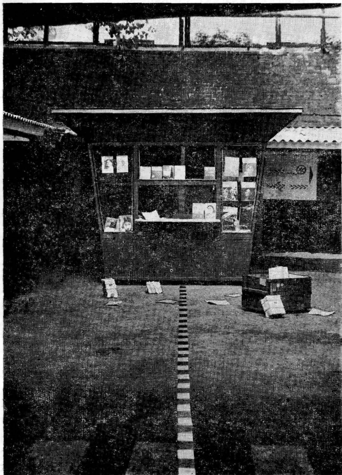
Рис. 56. Метрический фотоснимок с глубинным масштабом
