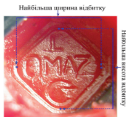
Рис. 1. Виміри основних розмірних характеристик відбитка матриці пломбіра
